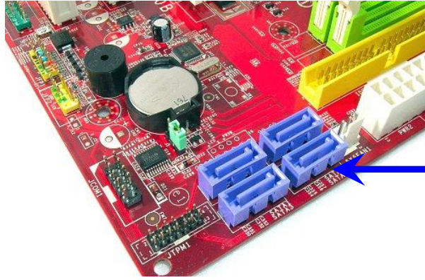
Şekil 2: 4 SATA konektörlü masaüstü bilgisayar ana kartı. Her bir sistemdeki konektör sayısı değişir.
