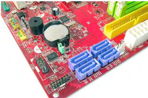
圖 2：配備 4 個 SATA 接頭的桌上型電腦主機板。 接頭數目會視系統而異。
