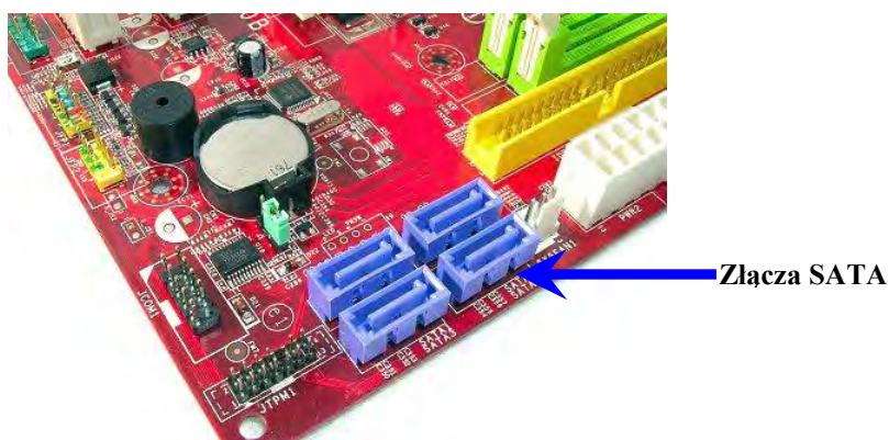
Rys 2: Płyta główna komputera stacjonarnego z 4 złączami SATA. Liczba złącz w danym systemie może być inna.
