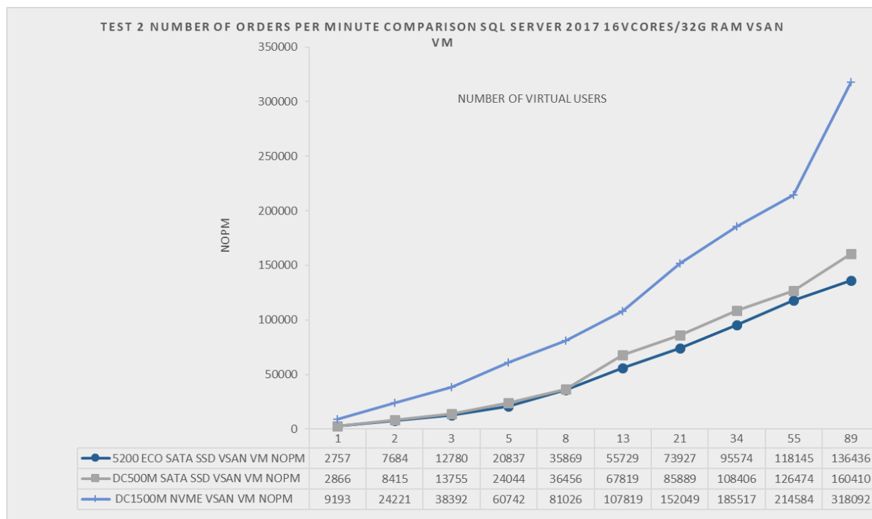
图3.3 测试2: NOPM 比较, NVME 与 SATA 两种 VSAN 数据存储
