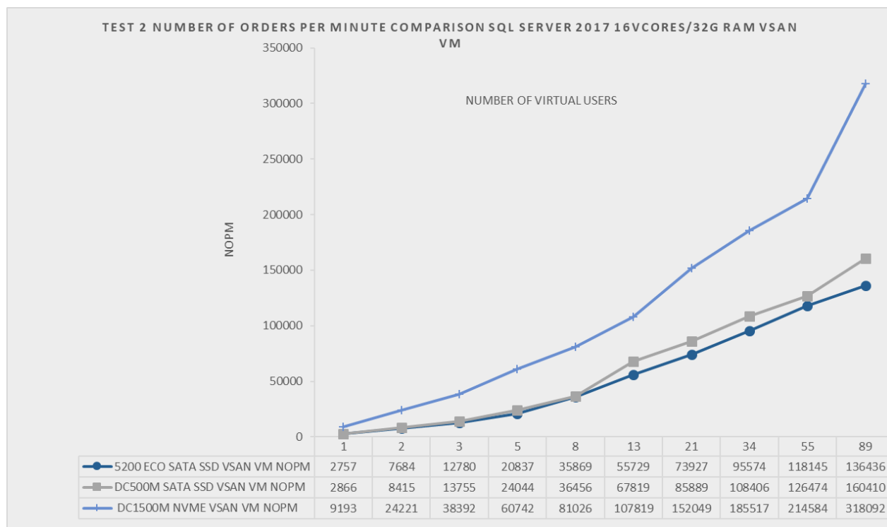
Рис. 3.3. Тест 2: сравнение NOPM для хранилищ данных VSAN на основе NVME и SATA
