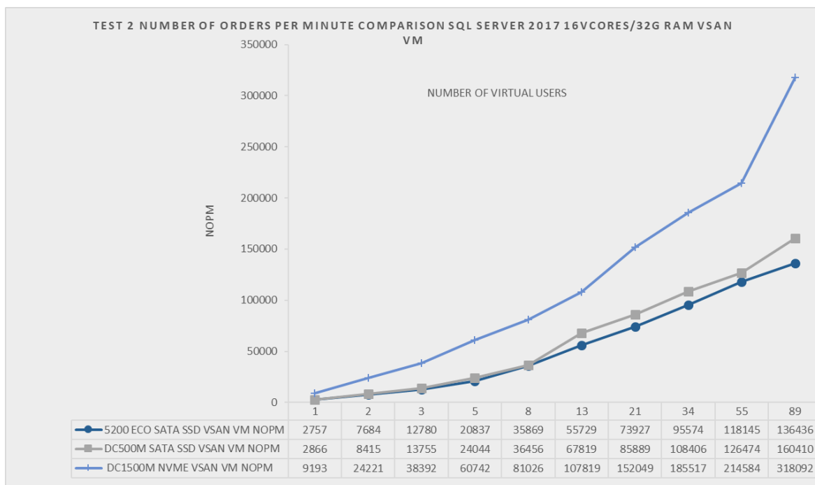
Мал. 3.2. Тест 2: порівняння кількості транзакцій на хвилину для vSAN систем зберігання даних NVMe та SATA
