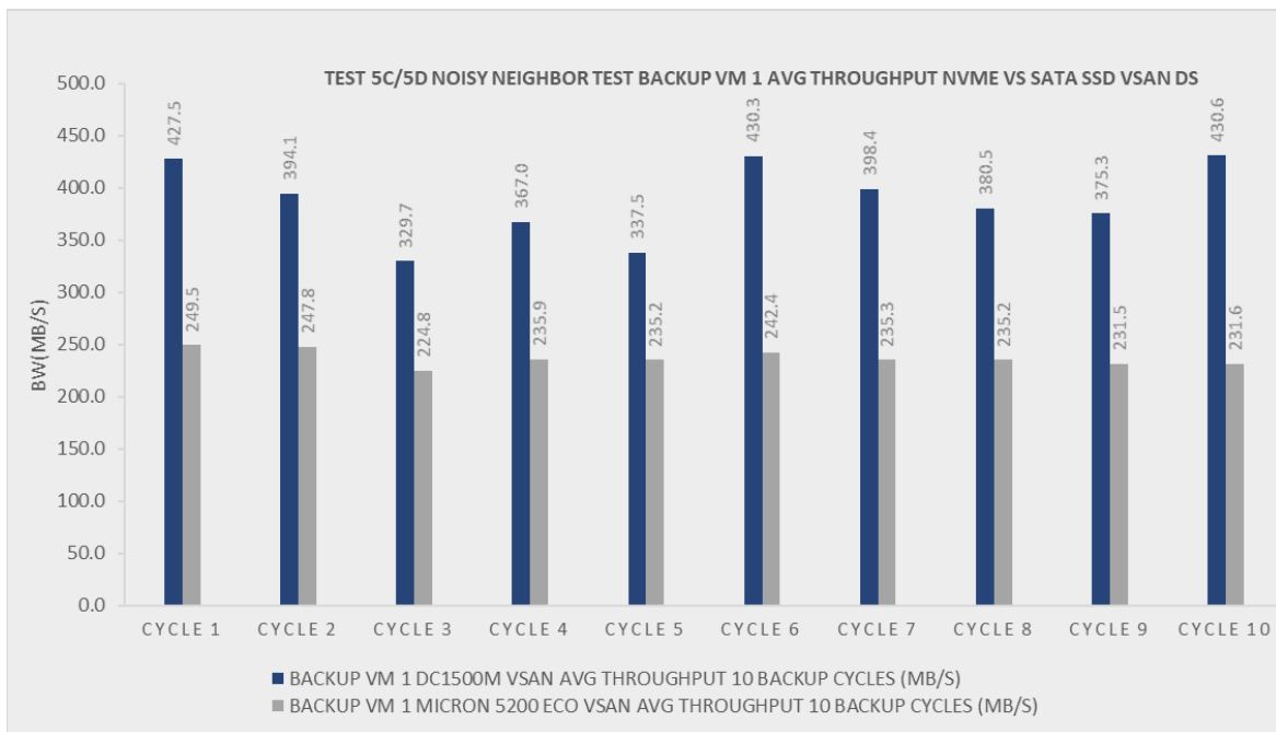
Мал. 6.10. Тести 5в/5г: пропускна здатність резервного копіювання віртуальної машини, проблема «галасливого сусіда», vSAN система зберігання даних на SSD-накопичувачах NVMe й SATA
