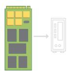
La technologie NVMe a été conçue pour les disques SSD. Elle communique entre l'interface de stockage et le processeur du système grâce à des sockets PCle à haut débit, indépendants du facteur de forme du stockage.
