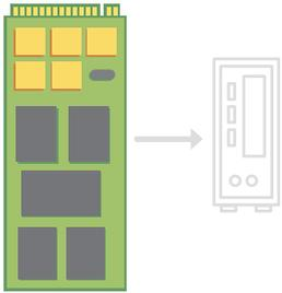
La NVMe fue diseñada para SSD. Se comunica entre la interfaz de almacenamiento y la CPU del sistema mediante ranuras PCIe de alta velocidad, independientemente del factor de forma del almacenamiento.
