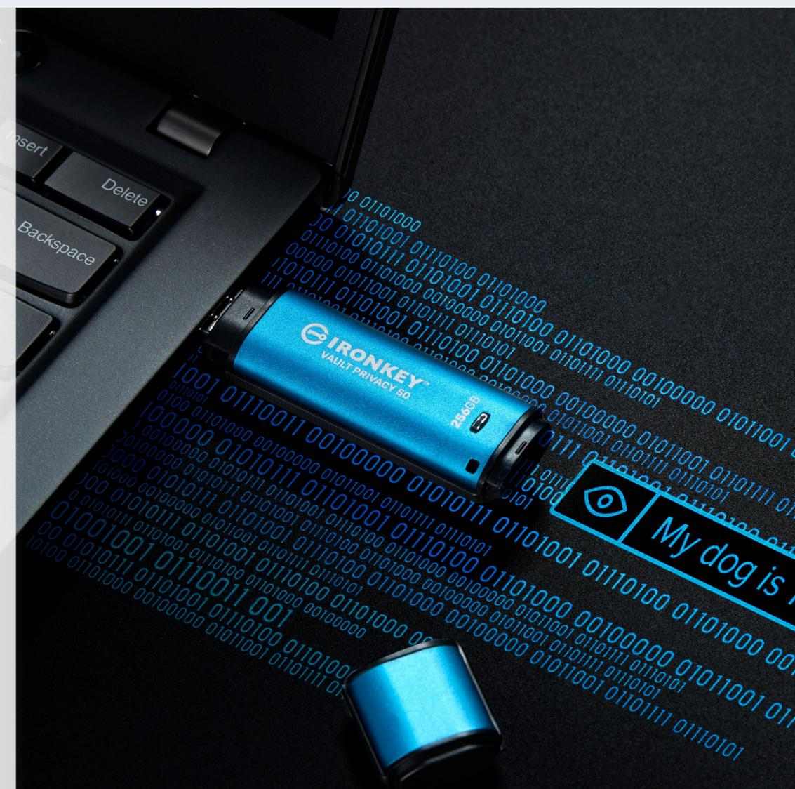
Si el dispositivo IronKey detecta que el firmware ha sido manipulado, bloqueará el dispositivo y no arrancará, mejorando así la ciberseguridad.
