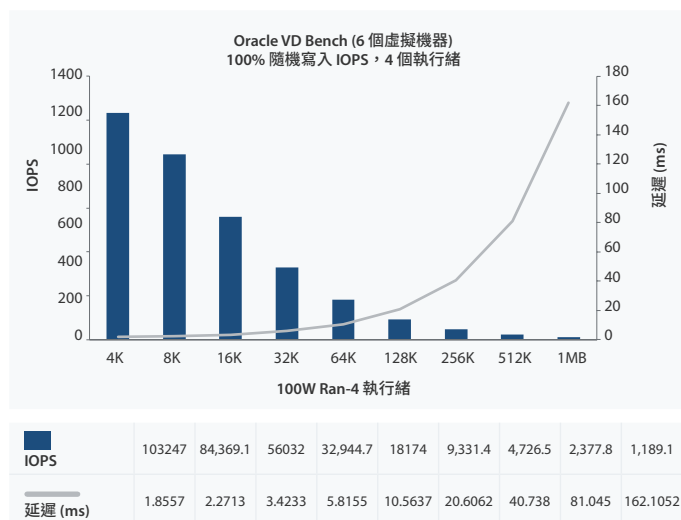
圖 1.5 隨機寫入效能, Kingston DC600M 3840G 9 硬碟 vSAN 資料儲存。
