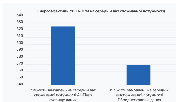
Рис. 3.3. Стрес-тест енергоефективності гібридного і All-Flash сховищ даних vSAN з накопичувачами DC600M із 89 користувачами
