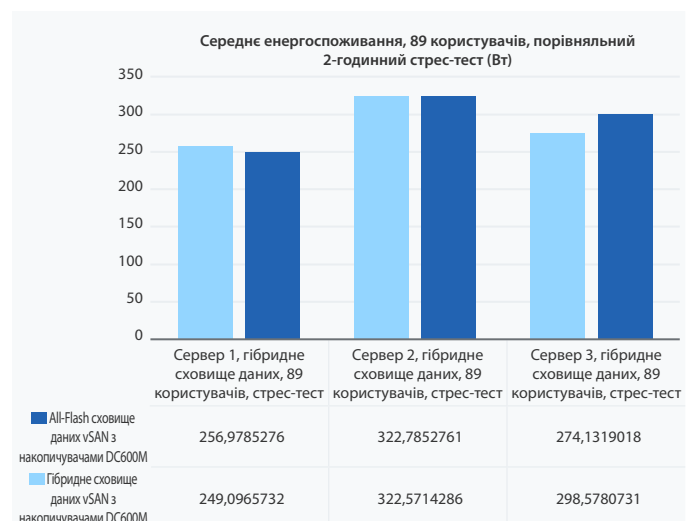
Рис. 3.2. Стрес-тест середнього енергоспоживання гібридного і All-Flash сховищ даних vSAN із 89 користувачами
