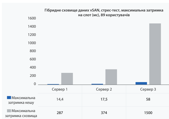
Рис. 3.6. Максимальна затримка LCT (мс) по DPMstat гібридного сховища даних із 89 користувачами, стрес-тест
