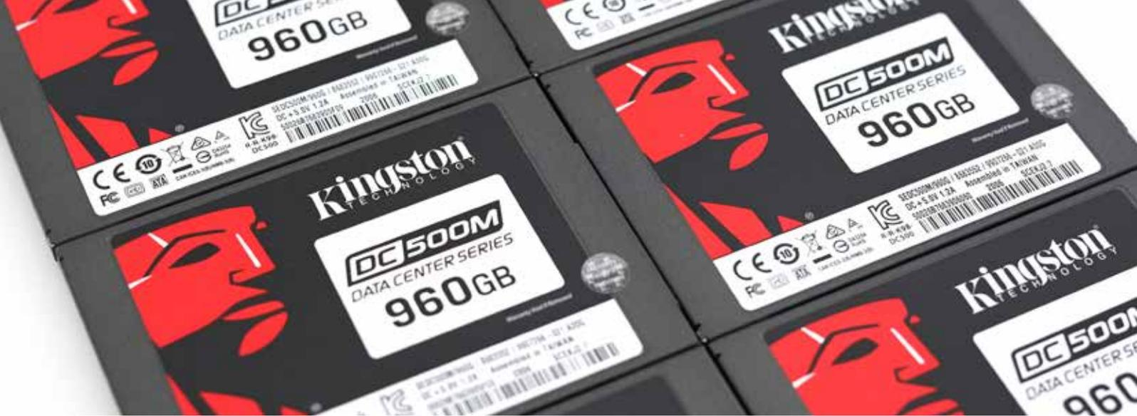
установленному в Synology FS3017, стало возможным последовательно считывать массив со скоростью примерно 520 МБ в секунду при низком количестве операций ввода-вывода в секунду для 4К данных, что является привычным для дисков явлением.
