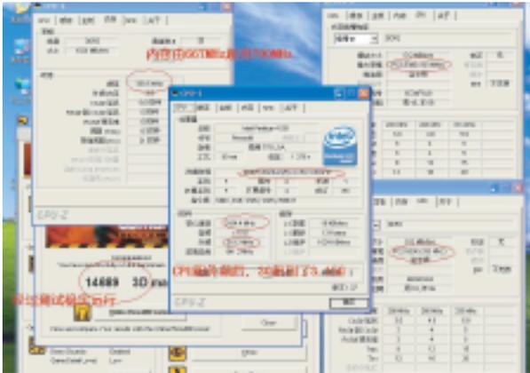
可以看到CPU主频由3GHz超到3.15GHz，外频210MHz，倍频15。
