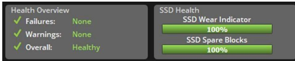
L'indicateur d'usure du SSD peut être utilisé pour vérifier l'état de la garantie conditionnelle de votre SSD Kingston®. Une valeur de 1 % pour les SSD SATA ou de 0 % pour les SSD NVMe indique que le disque est hors garantie. **Il est conseillé de faire une sauvegarde de vos données et de cesser d'utiliser tout disque ayant atteint une valeur d'indicateur d'usure du SSD de 1 % ou moins.**
