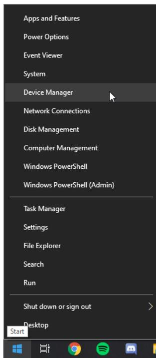
2. В области **Device Manager** (Диспетчер устройств) разверните раздел «*Sound, video and game controllers*» (Контроллеры звука, видео и игр).
