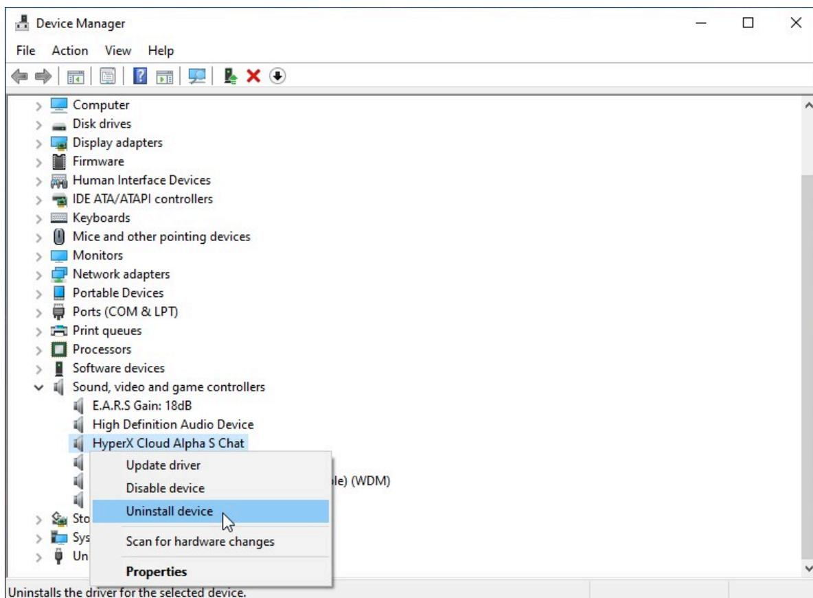
6. Kliknij przycisk „*Odinstaluj*”, aby odinstalować sterownik urządzenia USB **HyperX Cloud Alpha S Chat**.
