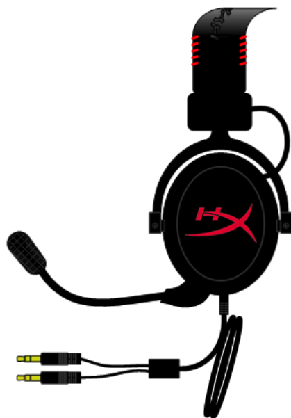
図 1.2 – 直接接続 (延長ケーブルなし)
